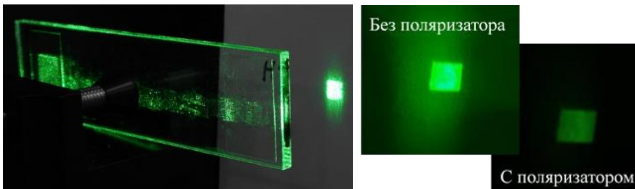
а) расширитель пучка для длины волны 532 нм
