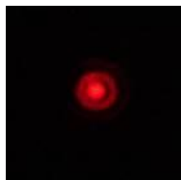
в) микрофотография кружка рассеяния этой линзы ( \lambda = 632,8 нм, диаметр кружка рассеяния — 4 мкм, увеличение ~ 1000×)
