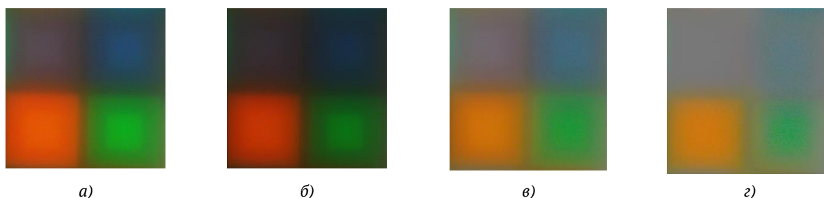
Рис. 2. Изображения участка светотехнической таблицы, полученные в мультиапертурной системе каждой из 4 линз
