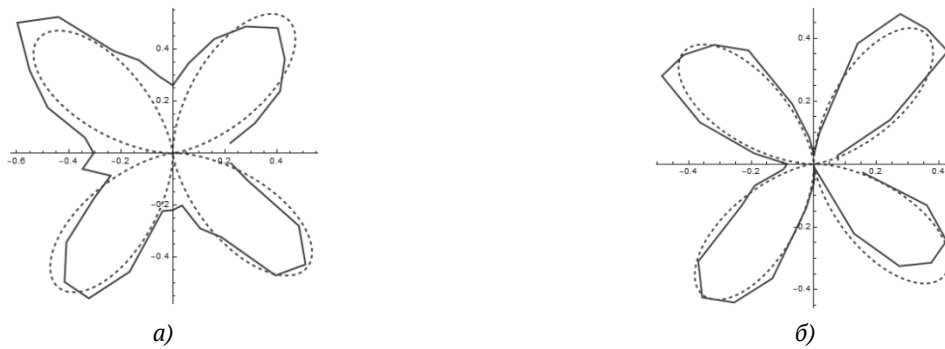
Рис. 1. Зависимость дифракционной эффективности коротко- (а) и долгоживущей решетки (б) от угла ориентации кристалла
