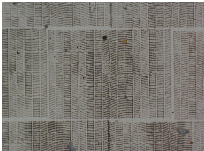
Рис. 8. Фотография участка фоторезиста с нанесённой на него структурой интерференционных полос, сформированная с использованием скомпилированных в рис. 5б ракурсов объекта голографирования
