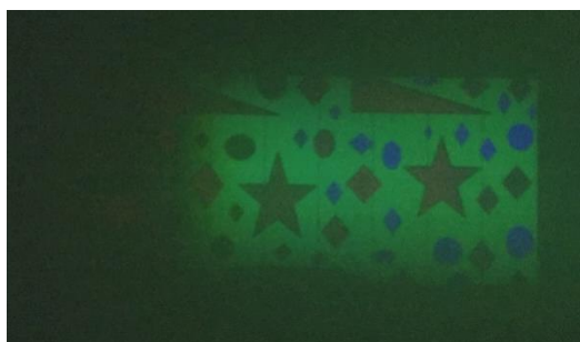
Рис. 8. Сине-зелёный FOV, проведенный через перископную систему, записанную на образце состава типа Ge-S
