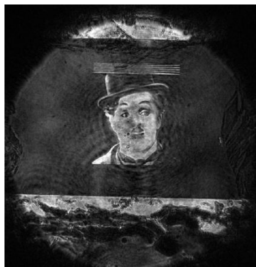
Рис. 3. Восстановленное изображение объекта: портрет Чарли Чаплина, перенесенный на голографическую пластину с уменьшением (размер объекта \approx 1 мм)
