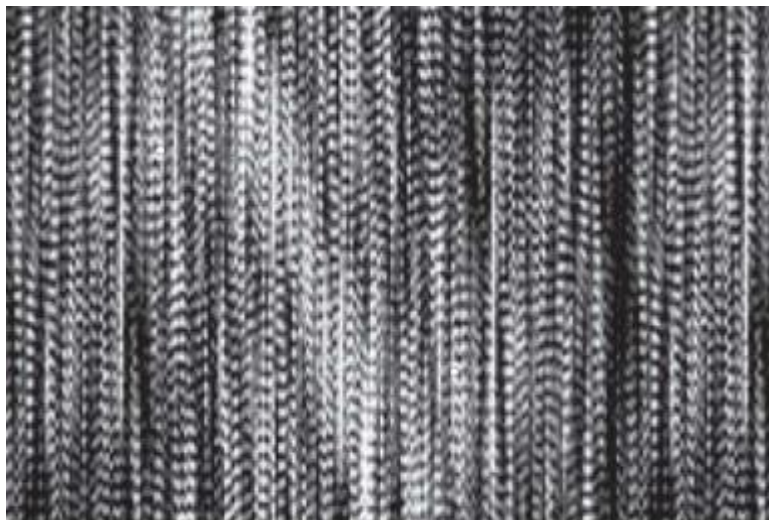
Рис. 3. Структура вытянутых вертикально спеклов радужных голограмм С. Бентона с ориентированными поперечно под разными углами интерференционными полосами, образованными интерференцией пространственно отфильтрованного объектного и опорного пучка (рис. 2)
