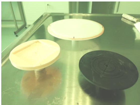
а) крепежная база для вакуумного прижима в центрифуге: заводская из фторопласта (белая), распечатки на 3D-принтере (кремового и черного цвета)
