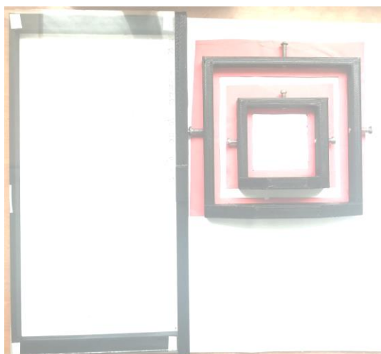
а) технологические рамки для различных размеров заготовок: 220×160 мм (слева), 120×120 мм (справа) и 60×60 мм
