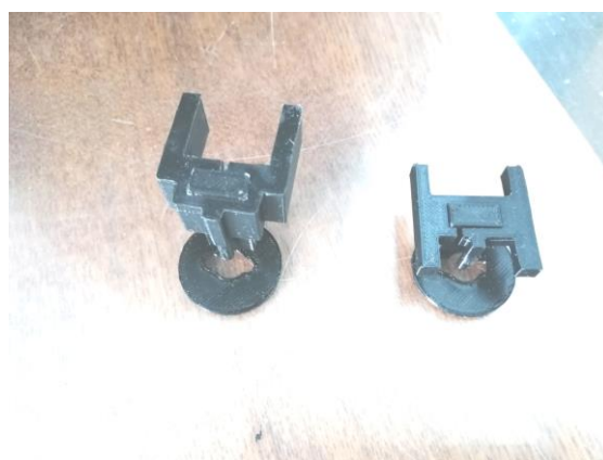
б) рамка с прижимной системой заготовок для литографии
