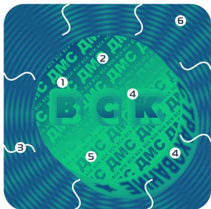
1 — микротекст 300 мкм «ВСК»; 2 — микротекст 100 мкм «ВСК»; 3 — боковые просечки; 4 — эффект объема логотипа «ВСК» с надписью «СТРАХОВАНИЕ» на грани цилиндра; 5 — «зеркальный» текст высокой четкости «ДМС», «ВСК»; 6 — динамическое муаровое фоновое изображение; 7 — изменение контраста изображения при остром угле наблюдения; 8 — разрушаемая при попытке переклеивания основа с УФ свечением
