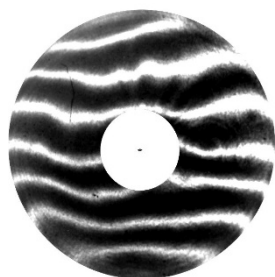
Рис. 10. Интерферограмма, характеризующая качество сформированного пучка лучей
