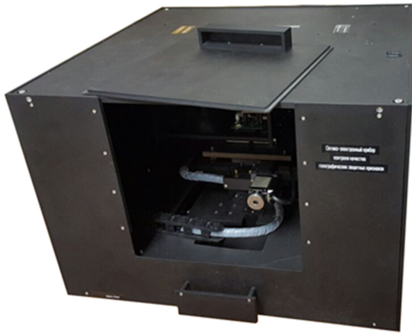
Рис. 2. Внешний вид макета ОЭП для контроля качества защитных голограмм
