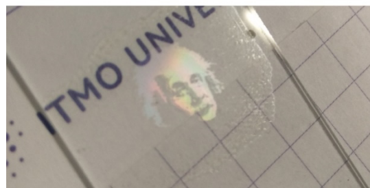
Рис. 2. Изображение, записанное голографическим методом
