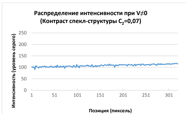
б) профиль интенсивности излучения (контраст 0,07)
