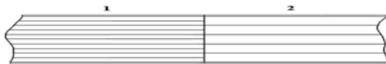
1 — отражает синий цвет, 2 — отражает красный цвет Рис. 1. Схема плоских зеркал в фотослое липпмановской фотографии
