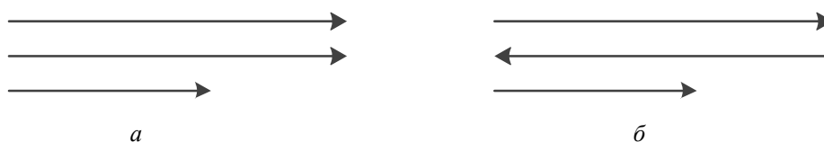
Рис. 2. Способы сканирования: а – в одном направлении; б – в двух направлениях (серпантин)
