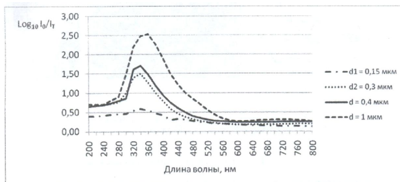
Рис. 2. Спектры поглощения пленок аморфного кремния в зависимости от длины волны излучения и для различных толщин слоя
