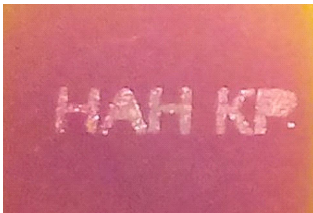
Рис. 4. Фотография прямой лазерной записи на спектральном интерференционном фильтре на пленке аморфного кремния излучением полупроводникового Blu Ray лазера с длиной волны 405 нм.
