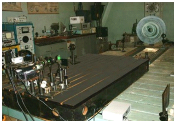
Рис. 3. Установка для исследования колебаний крупногабаритных деталей и узлов ГТД
