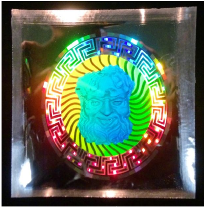
Рис. 2. Изображение КГ II-го поколения на основе объёмного аналогового изображения 3D-объекта. Представлена оригинация голограммы на никелевой мастер-матрице
